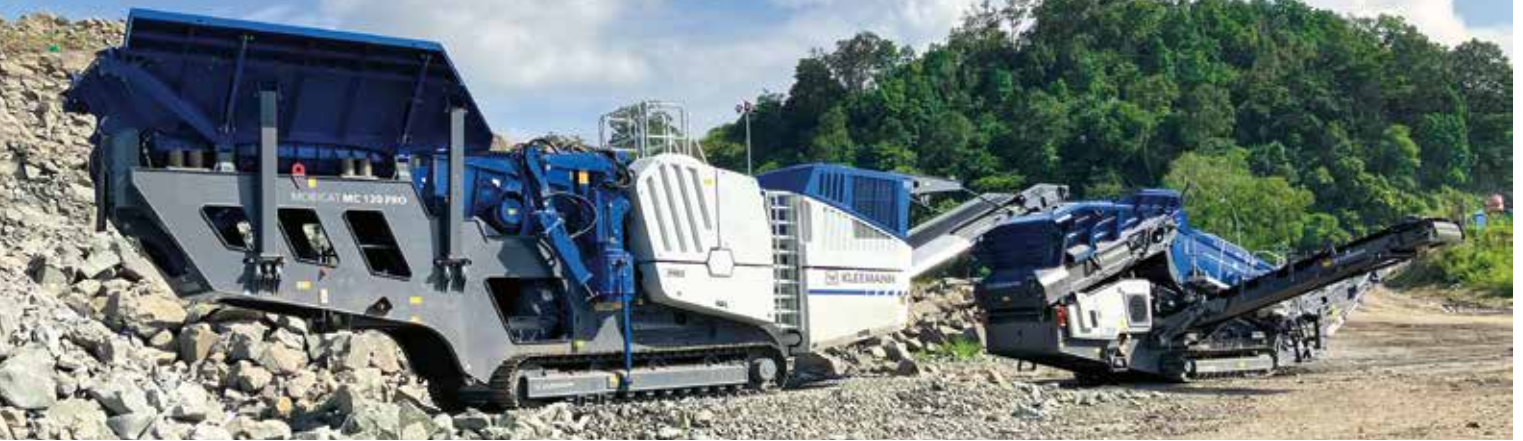
INGESPIELTES TEAM: Verketteter Anlagenzug bestehend aus Mobicat MC 120 Pro und Mobiscreen MSS 802 Evo von Kleemann. Fotos: Wirtgen Group
