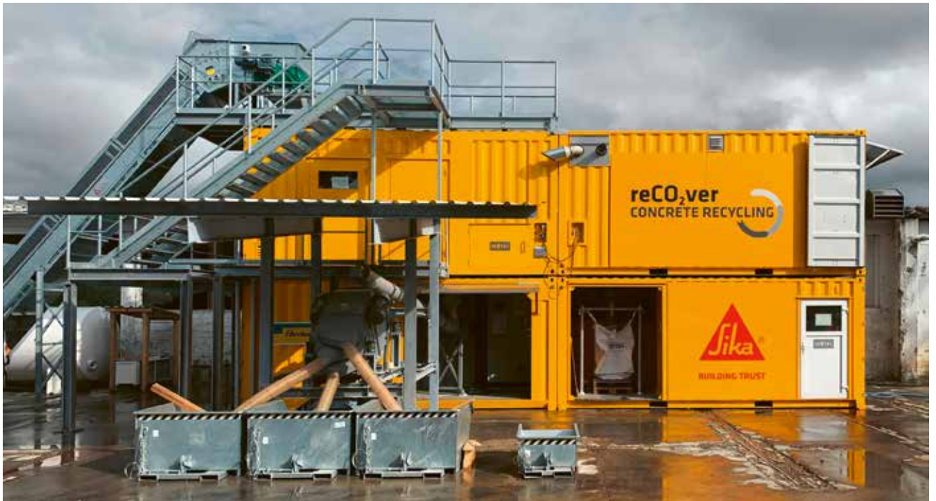
DIE PILOTANLAGE von Sika besteht aus vier Modulen, die die Größe eines Überseecontainers haben, sowie einer vorgeschalteten Förderanlage und einem nachgelagerten Siebmodul. Fotos: Sika AG
