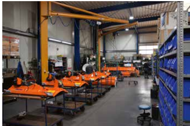
... HAT SICH FÜR DIE KLEINEREN TYPEN eine individuelle Montage in Fertigungslinien bewährt.
