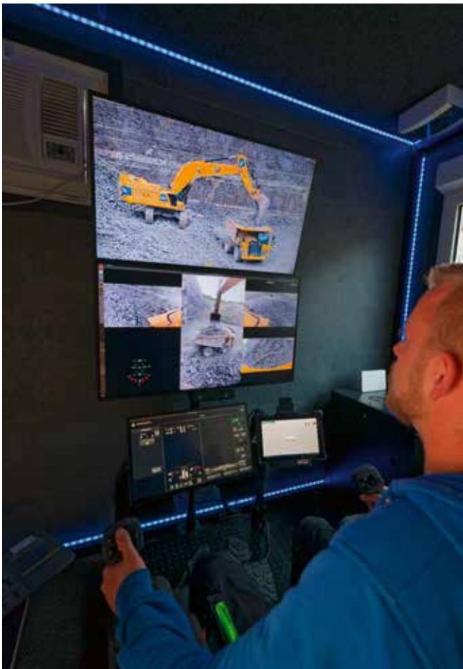
NEULAND FÜR DEN BEDIENER: Der Fahrer muss die Bewegung des Baggers über Monitore einstufen.
