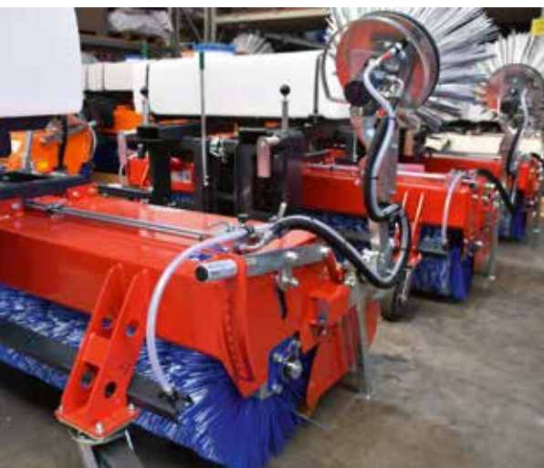
ALLEINSTELLUNGSMERKMALE: Die Rasterhebel zur Walzenverstellung haben sich in der Praxis bewährt und durchgesetzt.
