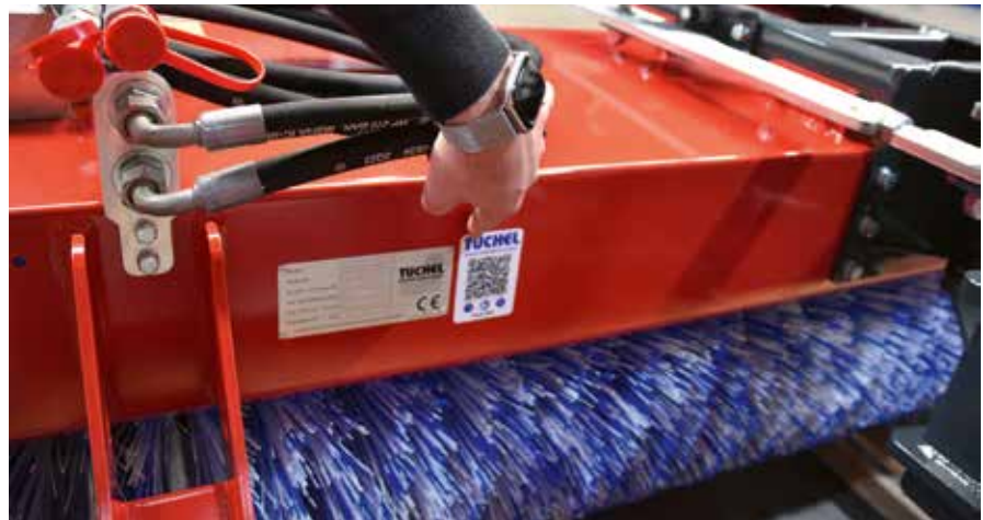
FORTSCHRITT AUCH IM KLEINEN: Zur Serviceoptimierung werden Tüchel-Kehrmaschinen mit digitalen Typenschildern versehen. Fotos: bwi
