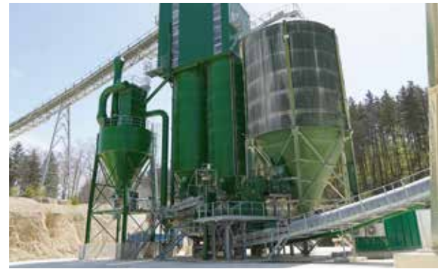
DIREKTER VERGLEICH: Vor der Modernisierung stand nur das große Puffersilo (l.) zur Verfügung, nun werden die unterschiedlichen Korngrößen in drei Puffersilos zwischengelagert.
