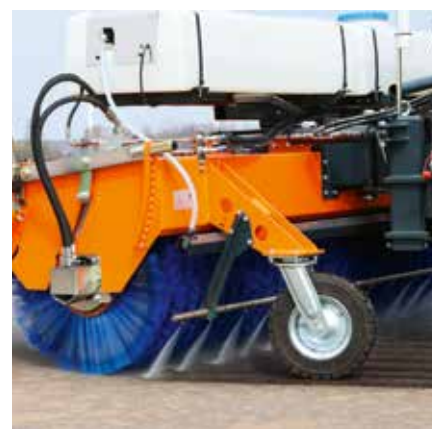
FÜR HARTNÄCKIGEN SCHMUTZ: Die großen Kehrmaschinen lassen sich mit einer leistungsstarken Hochdrucksprühanlage ausrüsten. Foto: Tuchel
