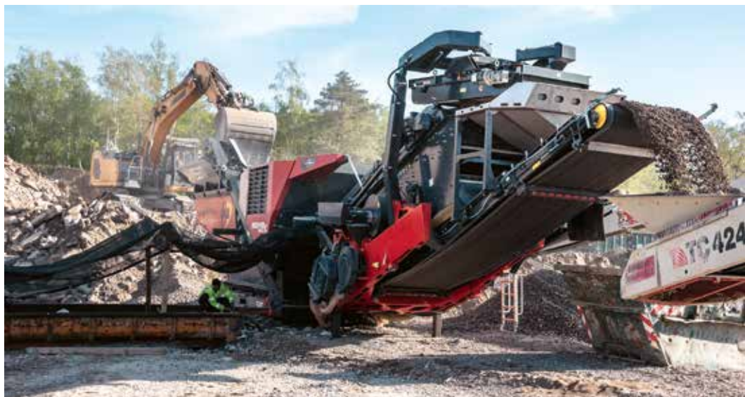
DURCHSATZSTARK ist die Maschine u. a. dank 1,80 x 5,50 m Siebgröße.
