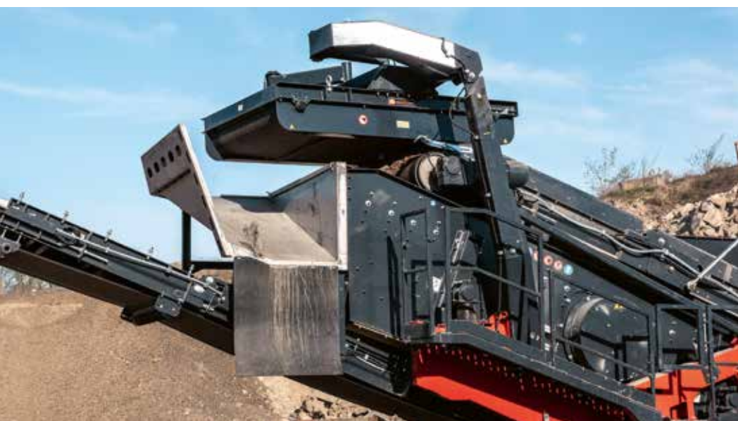
FÜR EIN HOCHREINES ENDPRODUKT sorgt u. a. ein Überbandmagnet mit optionalem Längsausstrag.
