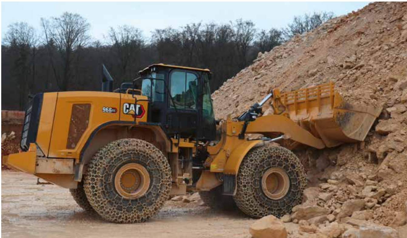
MIT KALKGESTEIN füllt der Radlader seine über 4 m 3 große Logmatic-Schaufel. Foto: Zeppelin
