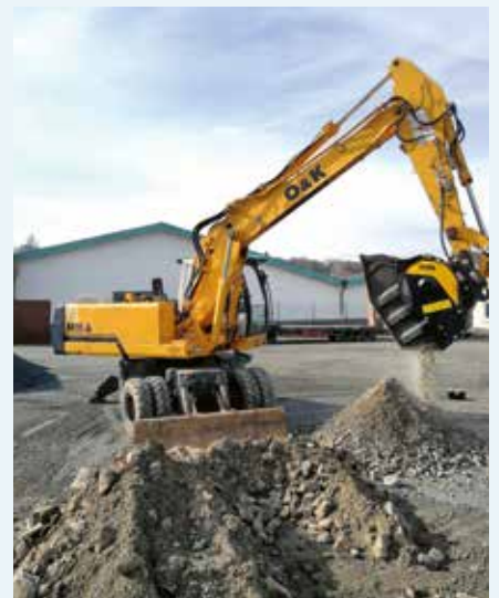
IM EINSATZ: der Backenbrecherlöffel BF80.3 von MB Crusher. Foto: MB Crusher
