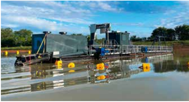
FÖRDERSTARK, FERNSTEUERBAR, WARTUNGSARM: Düchting-Saugbagger mit Baggerpumpe WRX 350-925. Fotos: Düchting
