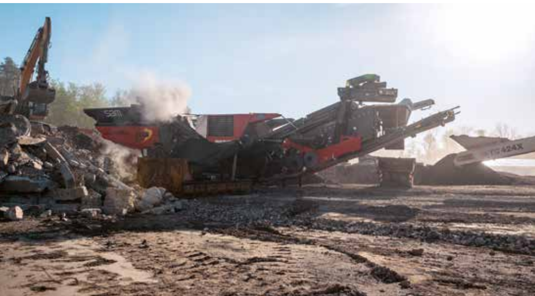
IHRE STÄRKEN spielt die Remax 600 bei der Aufbereitung von Rollfeld-Beton aus. Fotos: SBM
