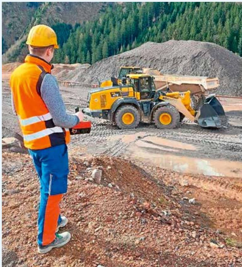
MIT FUNKFERNSTEUERUNG kommt der Radlader WA475 auch für Arbeiten in den Gefährdungsbereichen des Tagebaus zum Einsatz, ohne dass sich ein Mitarbeiter diesen Bereichen nähern muss.
