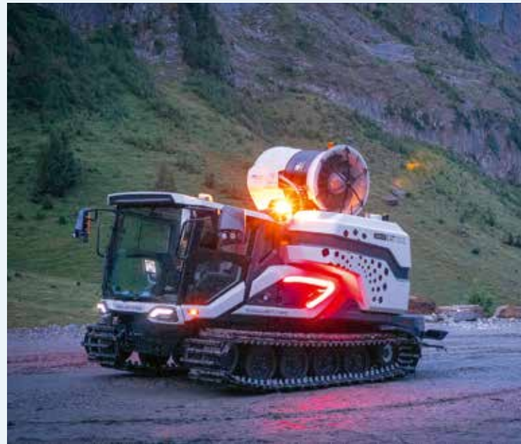
MODERN UND SICHER: Der Dust Cat 5000 ist ein hochmodernes Raupenfahrzeug zur autarken Staubbekämpfung. Fotos: Emi
