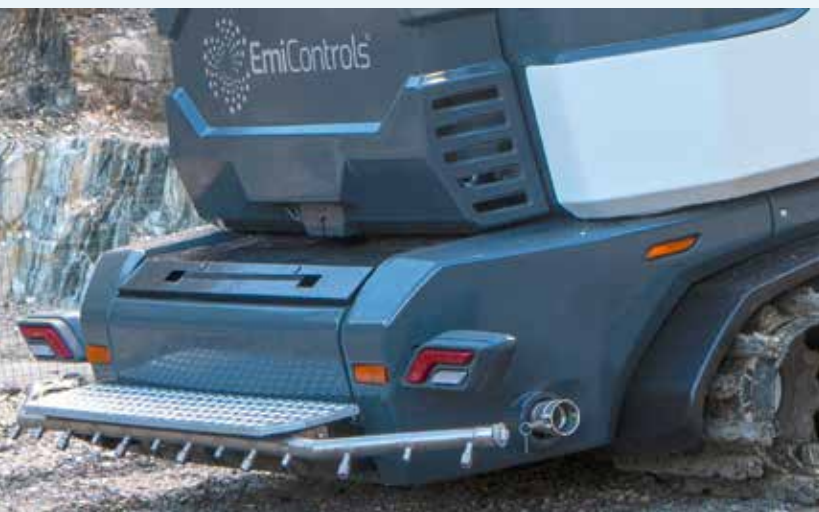
NUTZEN IM DETAIL: Der Sprühbalken am Heck sorgt für eine staubfreie Fortbewegung.
