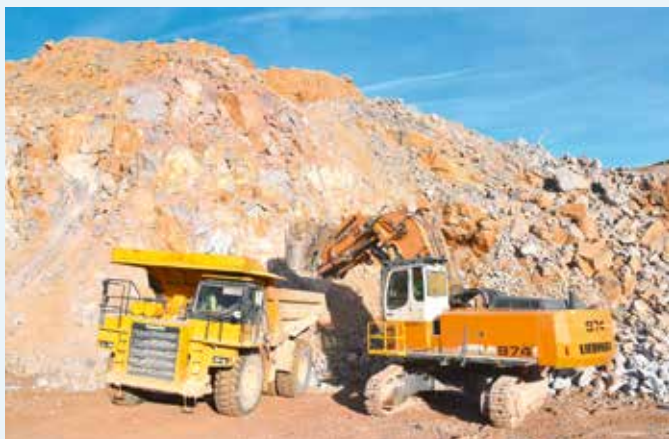
BEWÄHRTE GEWINNUNG: Im Steinbruch werden die Skw durch Hochlöf­felbagger be­laden, von denen gleich mehrere in Aktion sind.
