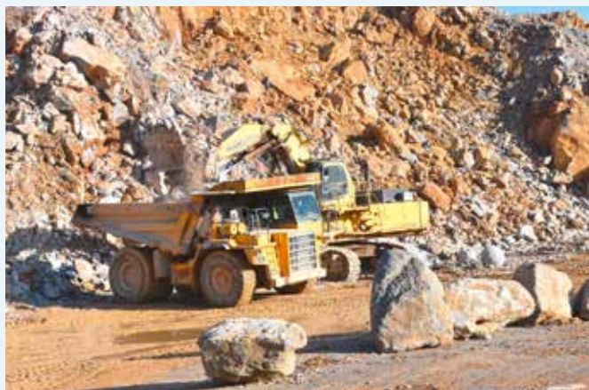
BEWÄHRTE GEWINNUNG: Im Steinbruch werden die Skw durch Hochlöf­felbagger be­laden, von denen gleich mehrere in Aktion sind.
