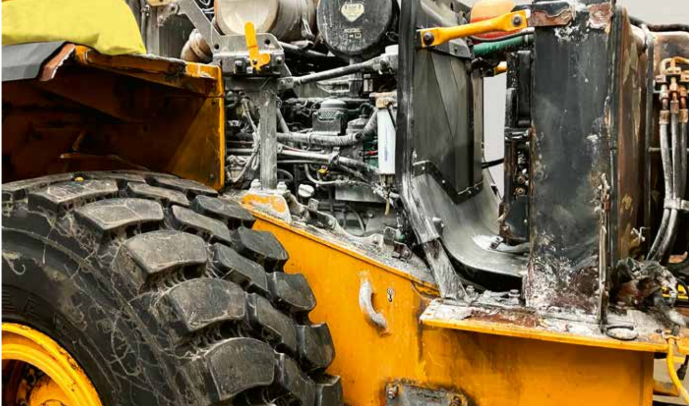
DEMONTAGE: Die Arbeiten des Radladers im Salz haben sichtlich zu starken Korrosionen geführt. Fotos: Swecon
