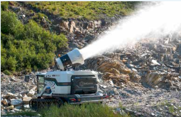
LANGE LEISTUNG: Mit dem 5000-l-Tank auf dem Rücken minimiert die Maschine wirksam Staub.
