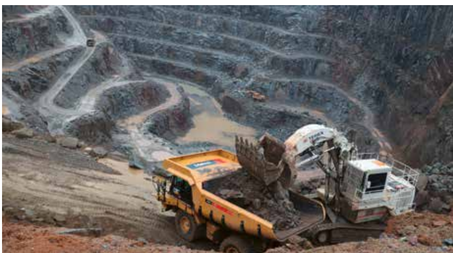
DIE GUMMIMULDE dämpft den Aufprall bei Beladung und Abkippergeräusche deutlich.
