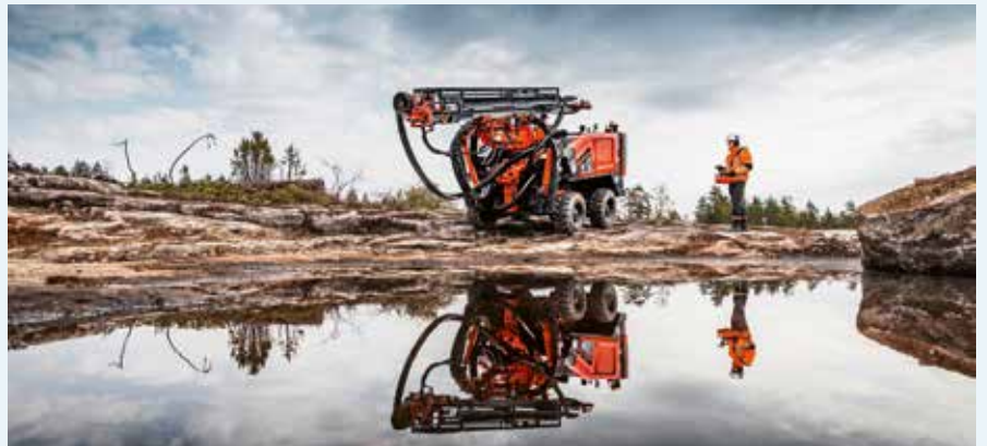
FLEXIBEL UND HOCHMOBIL: Der funkferngesteuerte Commando DC300Ri wird mit optionalen Funktionen zu einem echten Mehrzweck-Bohrgerät.
