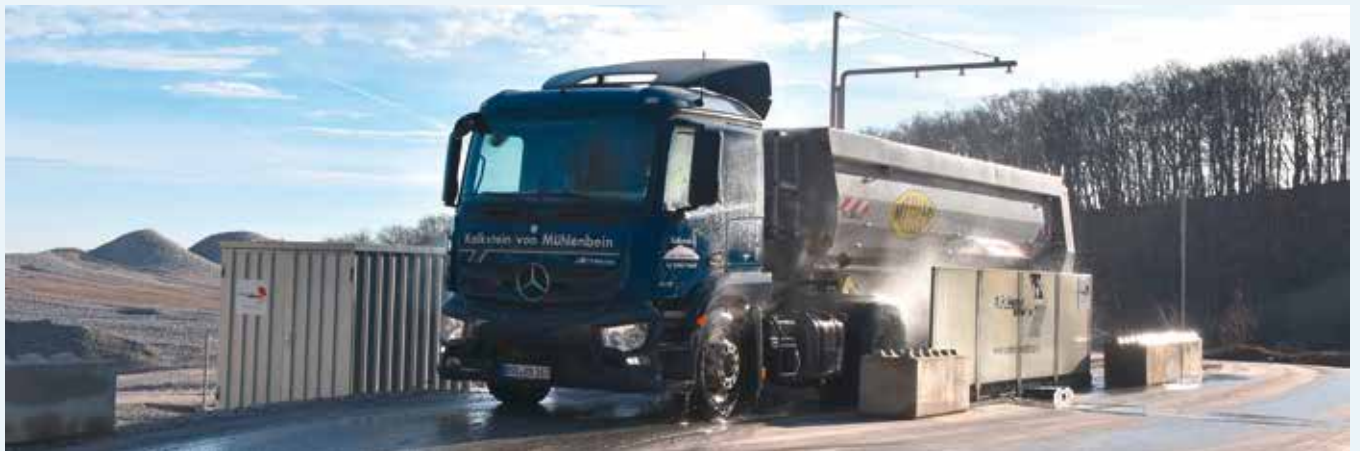
SAUBERE INVESTITION: Die moderne Wöhl-Reifenwaschanlage rundet die Ausstattung des Steinbruchs Mühlenbein ab.
