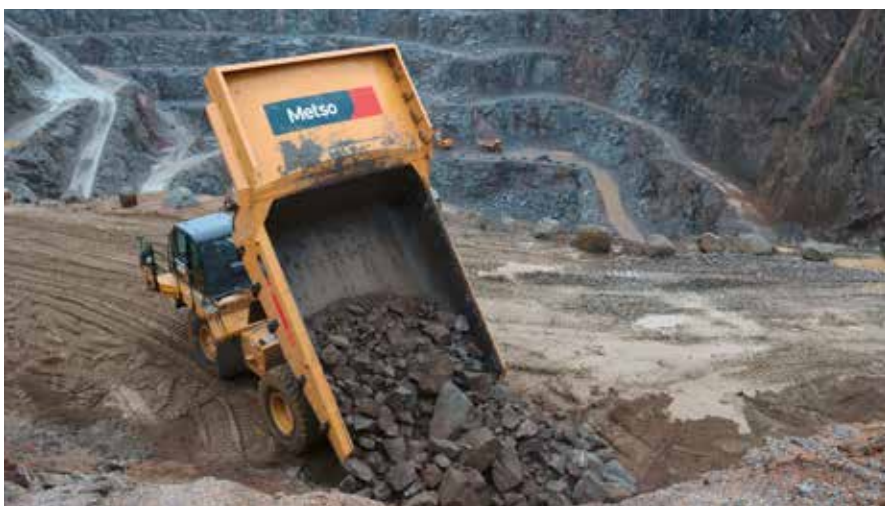
DER MULDENKÖRPER ist nicht mehr aus Stahl, sondern wurde von Metso mit 8 cm dickem Gummi, den die Zeppelin-Niederlassung Frankenthal montiert, versehen.
