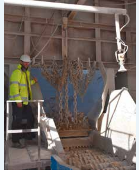
UNSCHEINBAR, ABER EFFEKTIV: Der kurze Müller-Rollenrost sorgt für effiziente Rohreinigung vor dem Primärbrecher.
