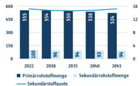
Abb. 39: Projektion der Primär- und Sekundärrohstoffmengen in Mio. t sowie der Sekundärstoffquote in % – obere Variante
